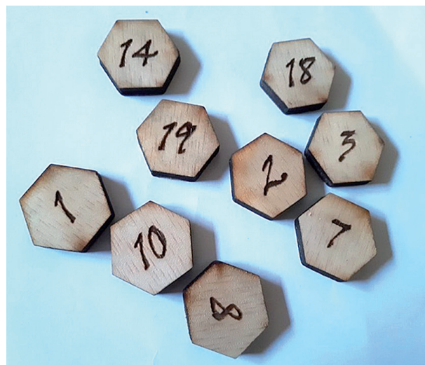
figuur 1 Houten spelonderdelen, gemaakt met de lasersnijder
