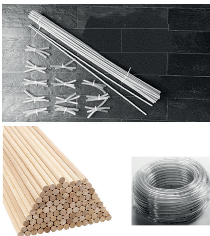
figuur 1 Het bouwpakket met gebruikte materialen: 32 stuks rondhout met een lengte van 90-100 cm en diameter 8-10 mm en 14 verbindingstukken
