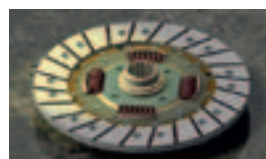
figuur 3 Vorm koppelingsplaat
