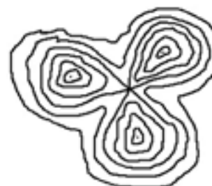
figuur 5 Hoogtekaart van twee kluiten die niet aan formule (1) voldoen
